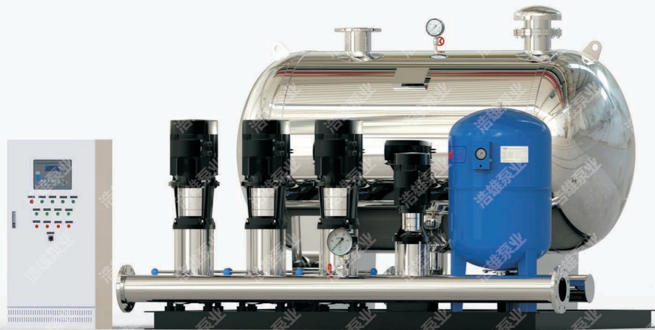
▲DWS系列罐式无负压变频供水设备平行式结构（进出水平行）样式图，设备控制柜根据控制功率、控制水泵台数和其他定制不同分为挂墙型、落地型和户外型。控制系统标准配置为微电脑单片机搭配中文液晶汉显按键屏（可配按键兼触摸屏或纯触摸屏），也支持定制PLC配大屏触摸屏。以上设备图片仅供参考样式，不作为每个型号的最终样式图，设备最终样式图受水泵规格和数量、气压罐规格、稳流罐规格和其他不同定制等因素的影响。
