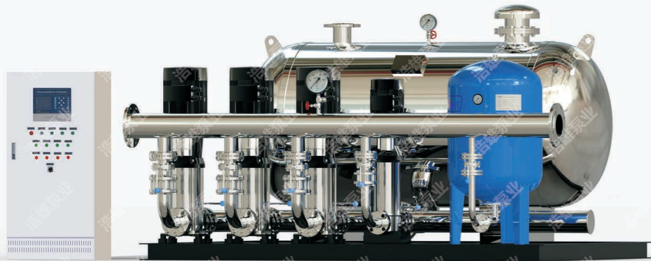
▲DWS系列罐式无负压变频供水设备垂直式结构（进出水垂直）样式图，设备控制柜根据控制功率、控制水泵台数和其他定制不同分为挂墙型、落地型和户外型。控制系统标准配置为微电脑单片机搭配中文液晶汉显按键屏（可配按键兼触摸屏或纯触摸屏），也支持定制PLC配大屏触摸屏。以上设备图片仅供参考样式，不作为每个型号的最终样式图，设备最终样式图受水泵规格和数量、阀门类型、气压罐规格、稳流罐规格和其他不同定制等因素的影响。
