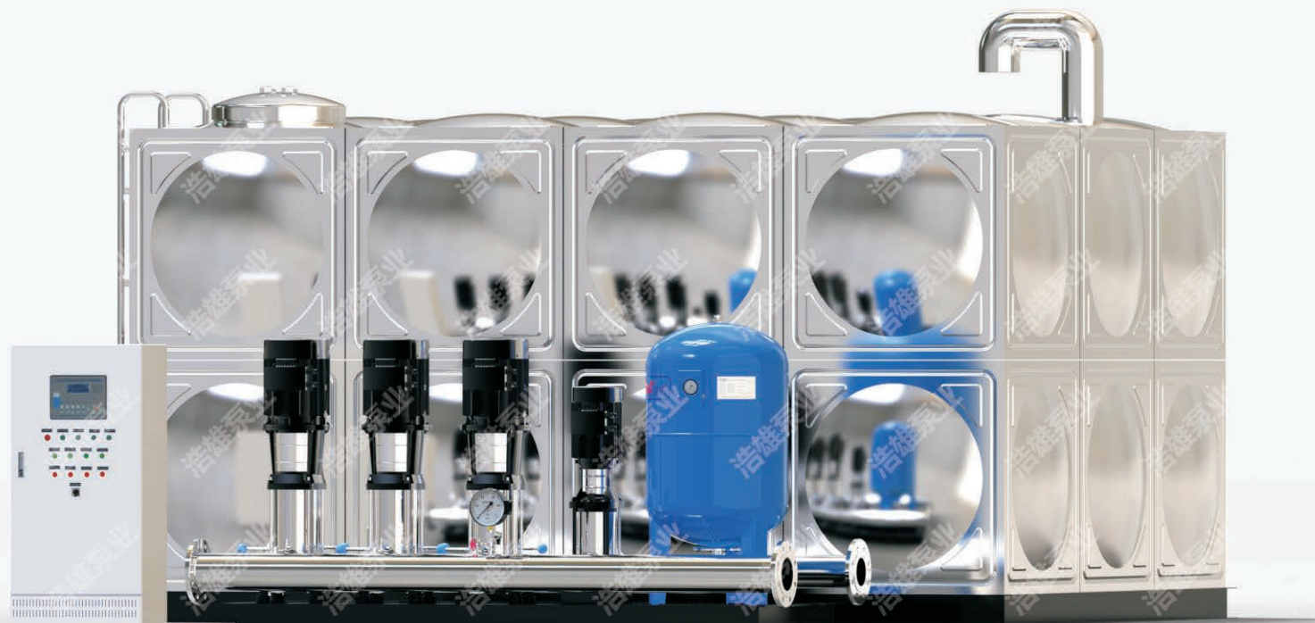
▲BWS系列箱式变频恒压供水设备平行式结构（进出水平行）样式图，组合式不锈钢水箱为选配。设备控制柜根据控制功率、控制水泵台数和其他定制不同分为挂墙型、落地型和户外型。控制系统标准配置为微电脑单片机搭配中文液晶汉显按键屏（可配按键兼触摸屏或纯触摸屏），也支持定制PLC配大屏触摸屏。以上设备图片仅供参考样式，不作为每个型号的最终样式图，设备最终样式图受水泵规格和数量、气压罐规格和其他不同定制等因素影响。
